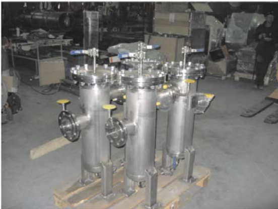
Haponkestävästä teräksestä valmistettuja nestesuodattimia.
